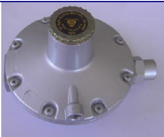
REGULATOR 20 kg/h – fiksni Pul=0,53-1,95 bar, Piz= 30-35 mbar Priključci: F1/2" –F3/4"
