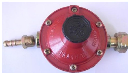
REGULATOR 4 kg/h – šteljući 20-60 mbar Priključna navrtaka CH27 ili CH25 Priključak za crijevo Ø8 / M3/8"
