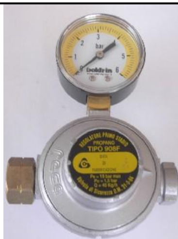
VISOKOTLAČNI REGULATOR 1° 40 kg/h – fiksni sa sigurnosnim ventilom i manometrom Max ulazni pritisak: 19 bara Izlazni pritisak: 1,5 bar Priključci: Nnavrtaka CH25 / F3/8"
