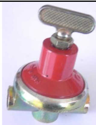
VISOKOTLAČNI REGULATOR 1° 12 kg/h – šteljući Max ulazni pritisak: 19 bara Izlazni pritisak: 0,5-3 bar Priključci: F1/4" / F1/4"
