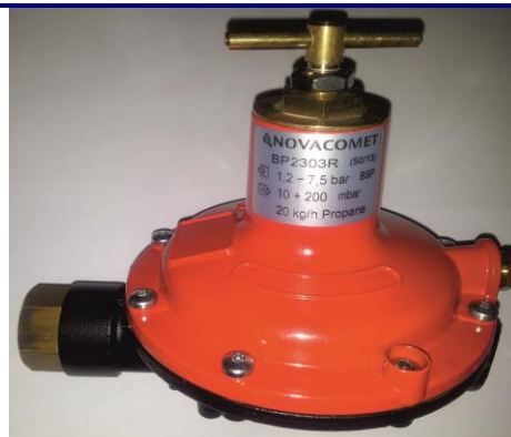
REGULATOR 20 kg/h – šteljući Pul= 1,2 – 7,5 bar, Piz= 10-200 mbar Priključci: F1/2" –F3/4"
