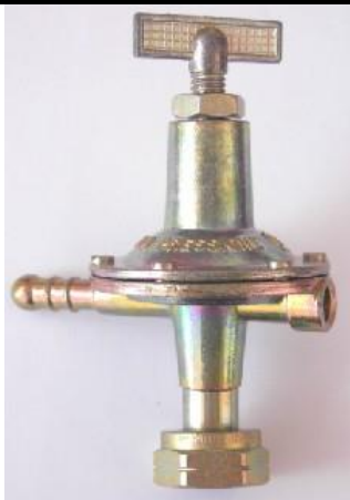
VISOKOTLAČNI REGULATOR 1° 6 kg/h – šteljući Max ulazni pritisak: 19 bara Izlazni pritisak: 0 - 3 bar Priključci: Navrtka CH27 / priključak za crijevo ili Navrtka CH25 / priključak za crijevo
