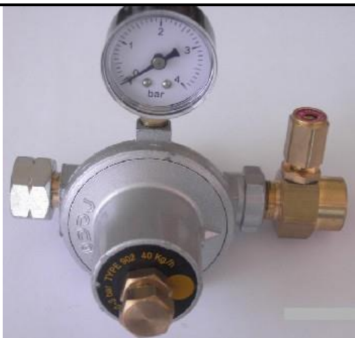
VISOKOTLAČNI REGULATOR 1° 40 kg/h – šteljući sa sigurnosnim ventilom i manometrom Max ulazni pritisak: 19 bara Izlazni pritisak: 0,5-2 bar Priključci: Nnavrtaka CH25 / F3/8"
