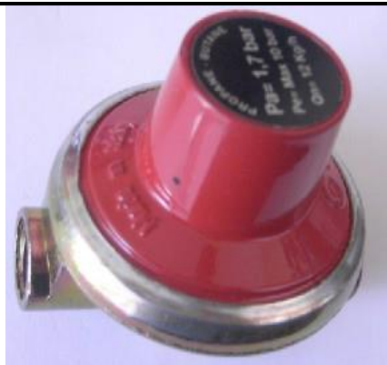
VISOKOTLAČNI REGULATOR 1° 12 kg/h – fiksni Max ulazni pritisak: 19 bara Izlazni pritisak: 1,7 bar Priključci: F 1/4" / F1/4"
