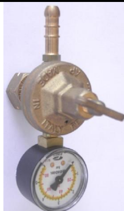
VISOKOTLAČNI REGULATOR 1° 6 kg/h – šteljući, sa manometrom Max ulazni pritisak: 19 bara Izlazni pritisak: 0 - 3 bar Priključci: Navrtka CH27 / priključak za crijevo ili Navrtka CH25 / priključak za crijevo
