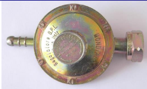
REGULATOR 1 kg/h – šteljući 20-60 mbar Priključna navrtaka CH27 ili CH25
